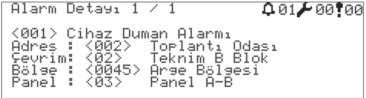
Şekil 11 - Alarm Detay Penceresi
